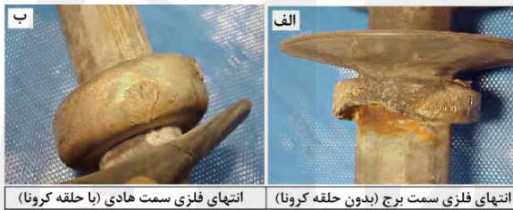
شکل ۶: خسارت وارد بر انتهای فلزی مقره کامپوزیتی ۲۳۰ کیلوولت الف) فاقد حلقه کرونا ب) با حلقه کرونا [۹]
